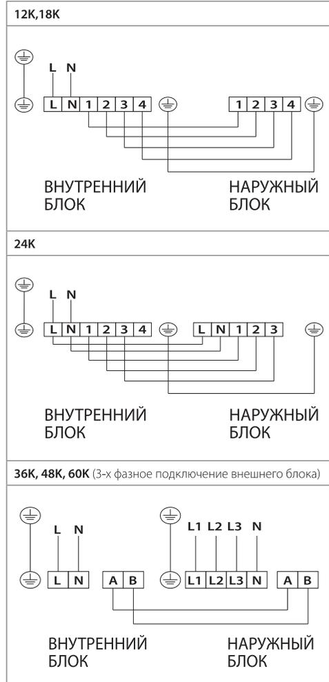
4.2. СХЕМЫ ЭЛЕКТРИЧЕСКИХ СОЕДИНЕНИЙ ВНУТРЕННИХ БЛОКОВ:
