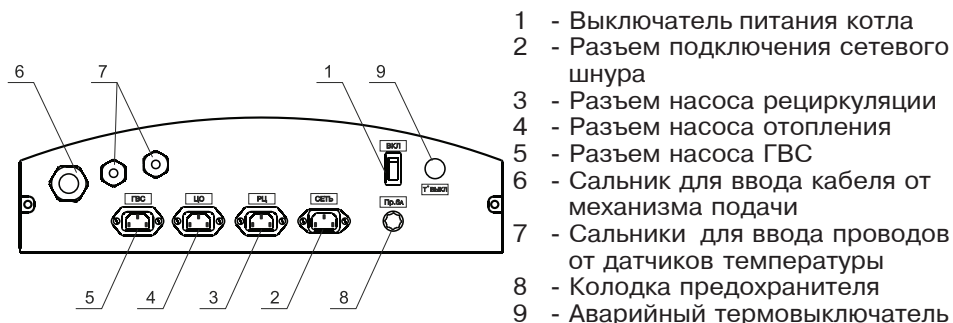
Рис.5 Расположение органов управления на задней панели пульта
