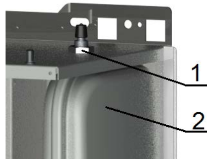
Рис. 20 Демонтаж расширительного бака
