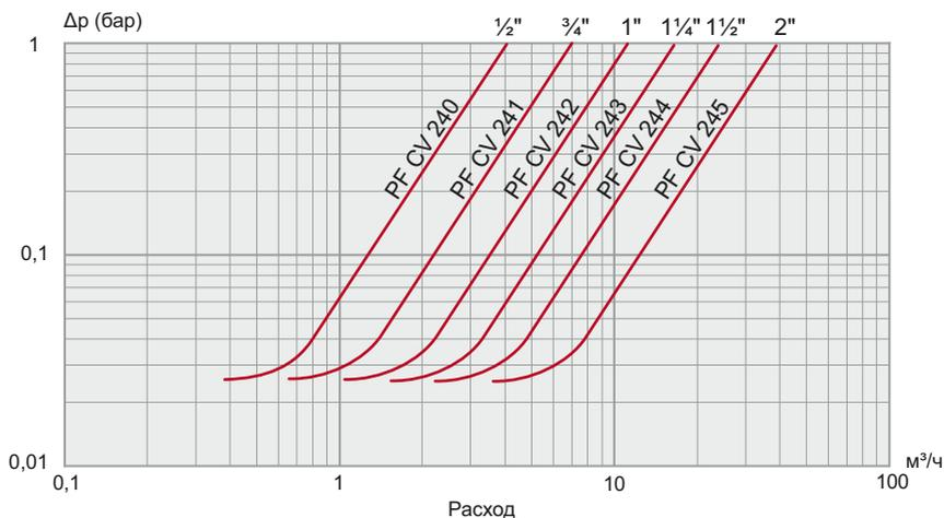
График минимального давления открытия клапана:
