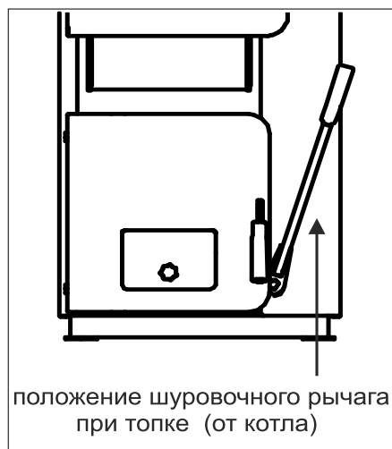
Рис. 10 Установка рычага шуровочного механизма
