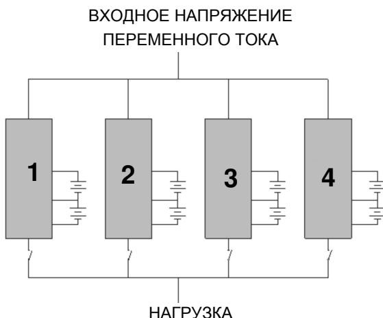
Рисунок 24 — Схема подключения изделий в систему параллельного резервирования.
