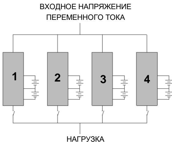
Рисунок 24 — Схема подключения изделий в систему параллельного резервирования.
