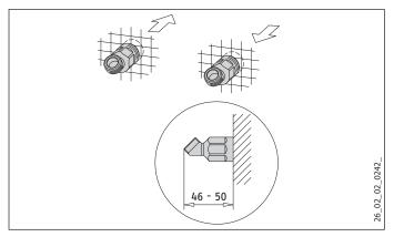
▶ Ввинтить оба соединительных патрубка. При этом соблюдать глубину их установки.
