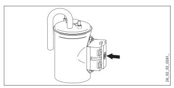
Обесточить прибор и стравить давление в водопроводе. Нажать кнопку включения предохранительного устройства ограничения температуры.
