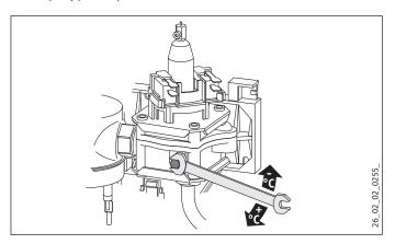
Отрегулировать объемный расход с помощью юстировочного винта таким образом, чтобы температура воды на выходе соответствовала указанной в главе «Технические характеристики / Таблица параметров».
