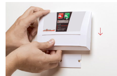
Навесить контроллер на пластину.
