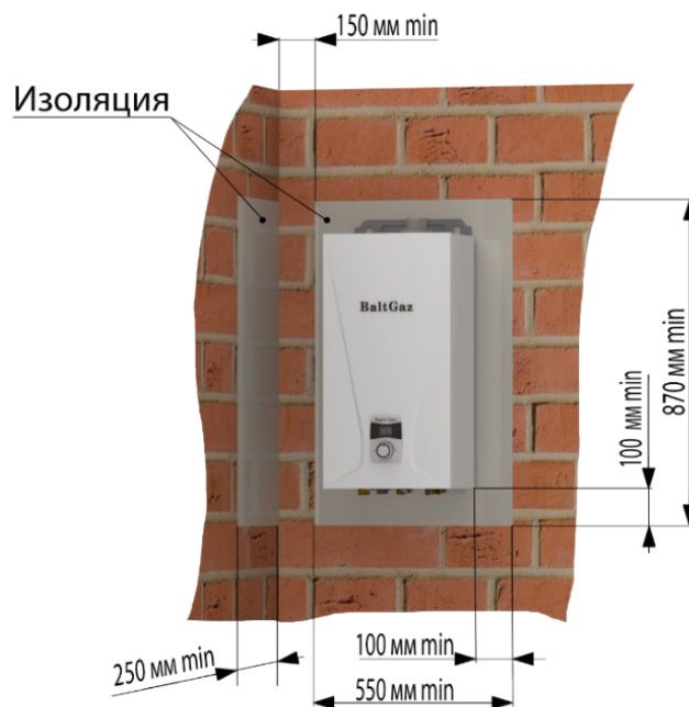
Рис. 6 Монтаж котла
